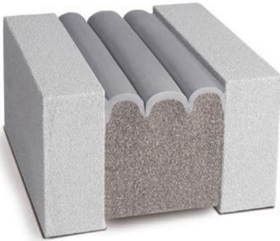
Le **système DSM** est un joint de dilatation primaire précompressé, adhérent aux faces du joint et résistant aux conditions de la circulation. DSM exploite un système breveté d'imprégnation de microsphères en acrylique modifié et d'un prérevêtement de silicone de classe autoroutière. Ce système repose sur plus de 30 années d'expérience dans le scellement de joints sur surfaces horizontales avec des produits d'étanchéité en mousse imprégnée.
