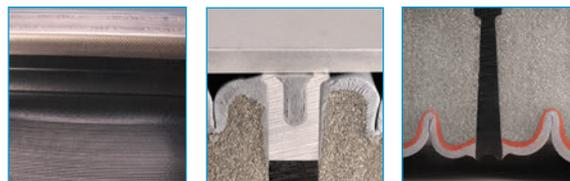
Les feuilles solin latérales en caoutchouc thermoplastique (à gauche) s'intègrent au système d'étanchéisation du tablier. Un soufflet de silicone étanche à l'eau (au centre) est posé sous la plaque de recouvrement carrossable. Une cannelure (à droite) descend à travers l'enduit ignifuge intumescent et le placage de silicone extérieur jusqu'à la sous-face du joint de dilatation SJS-FP-FR.
