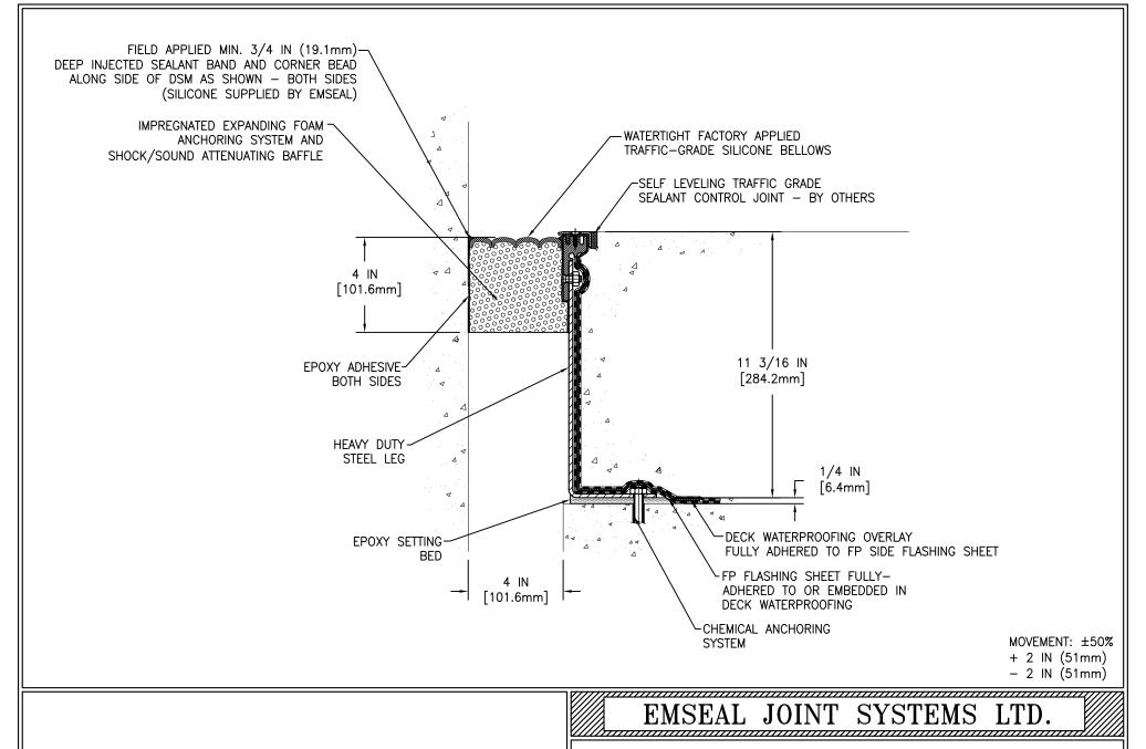
DSM-FP-0400-290 DECK TO WALL EXPANSION JOINT
