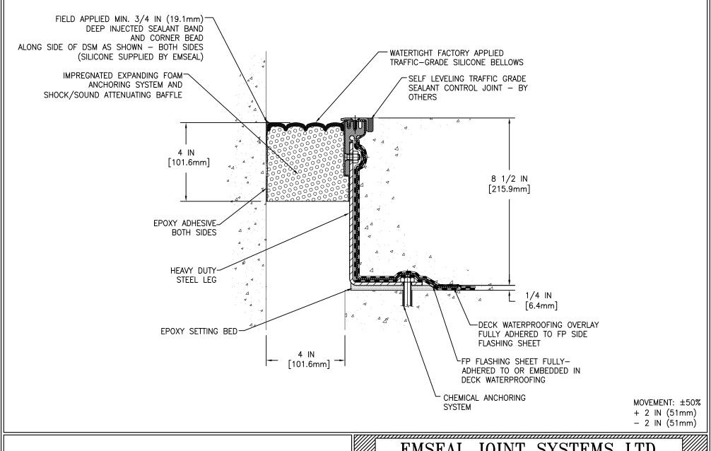
DSM-FP-0400-220 DECK TO WALL EXPANSION JOINT
