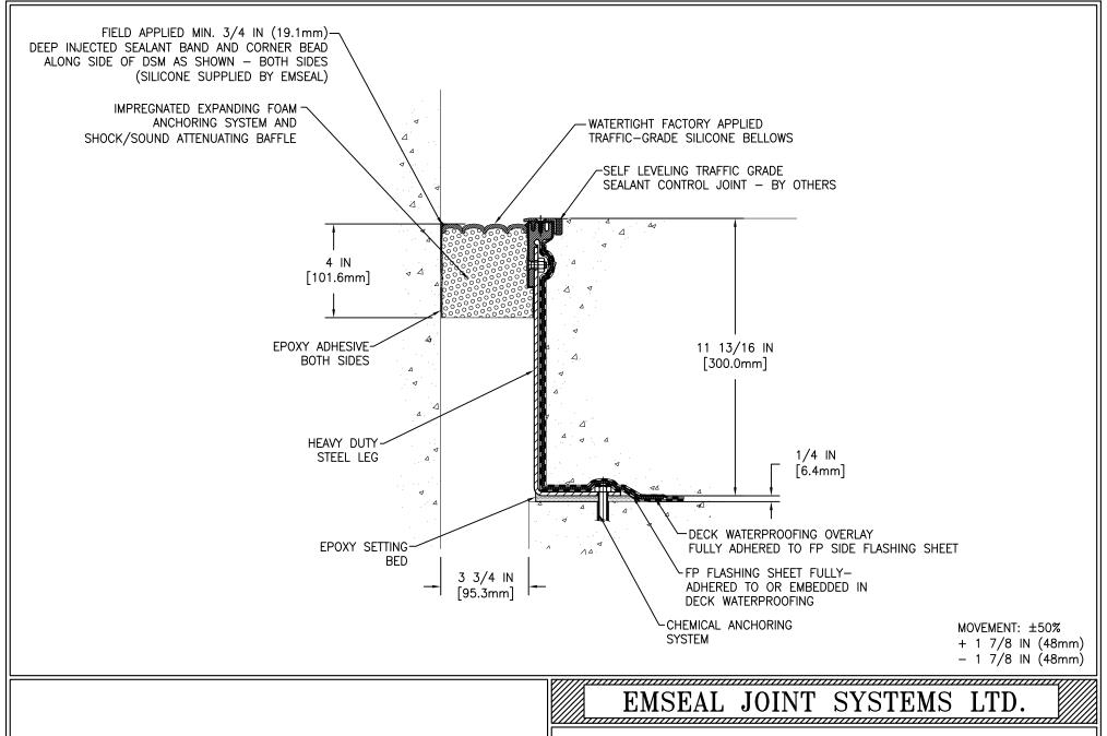
DSM-FP-0375-305 DECK TO WALL EXPANSION JOINT
