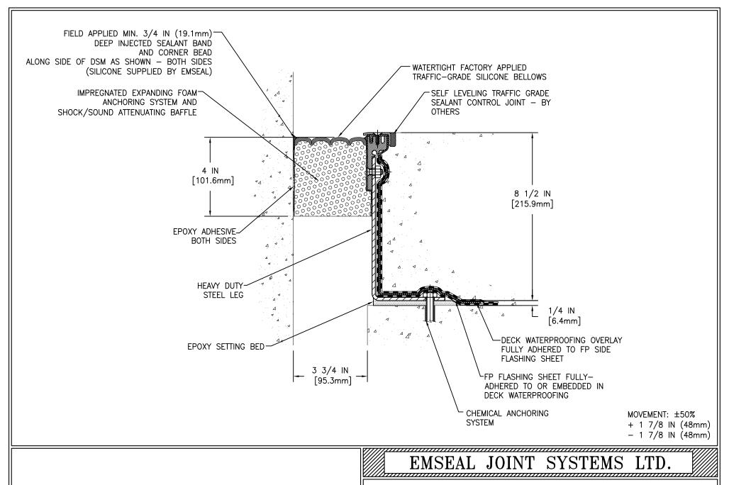
DSM-FP-0375-220 DECK TO WALL EXPANSION JOINT
