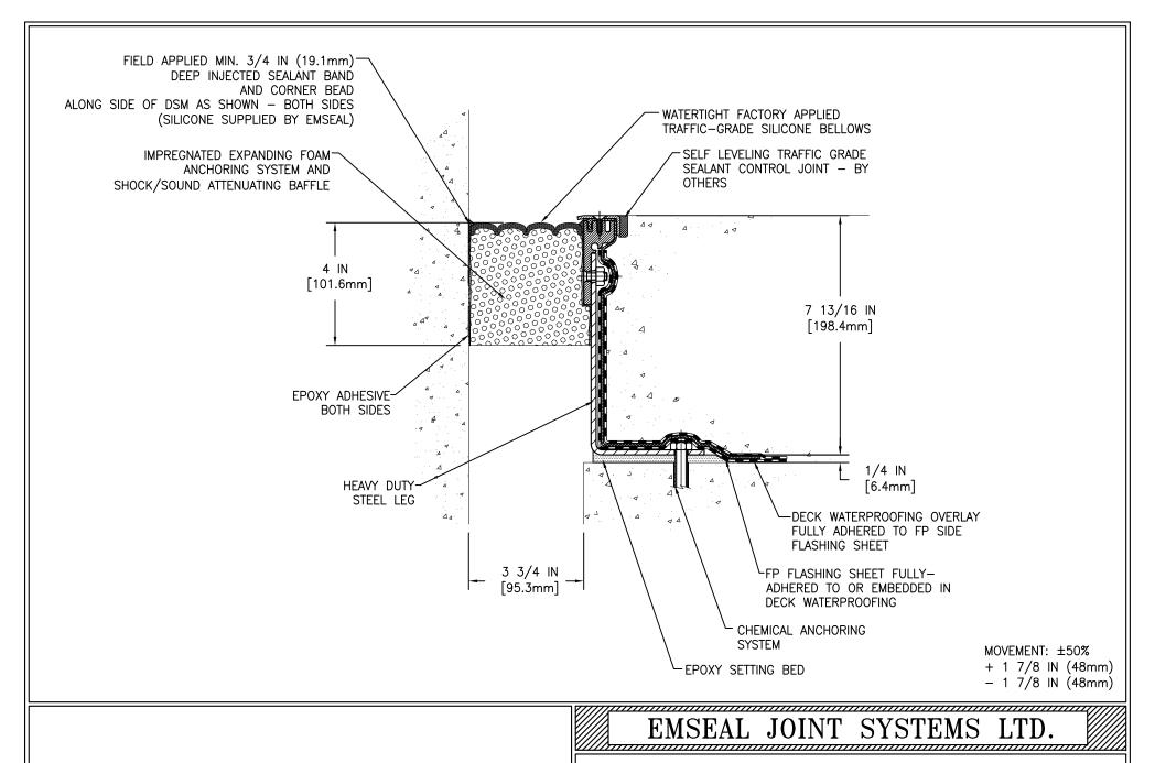
DSM-FP-0375-200 DECK TO WALL EXPANSION JOINT
