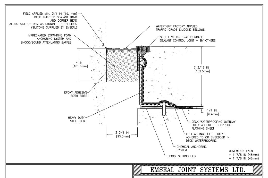
DSM-FP-0375-185 DECK TO WALL EXPANSION JOINT
