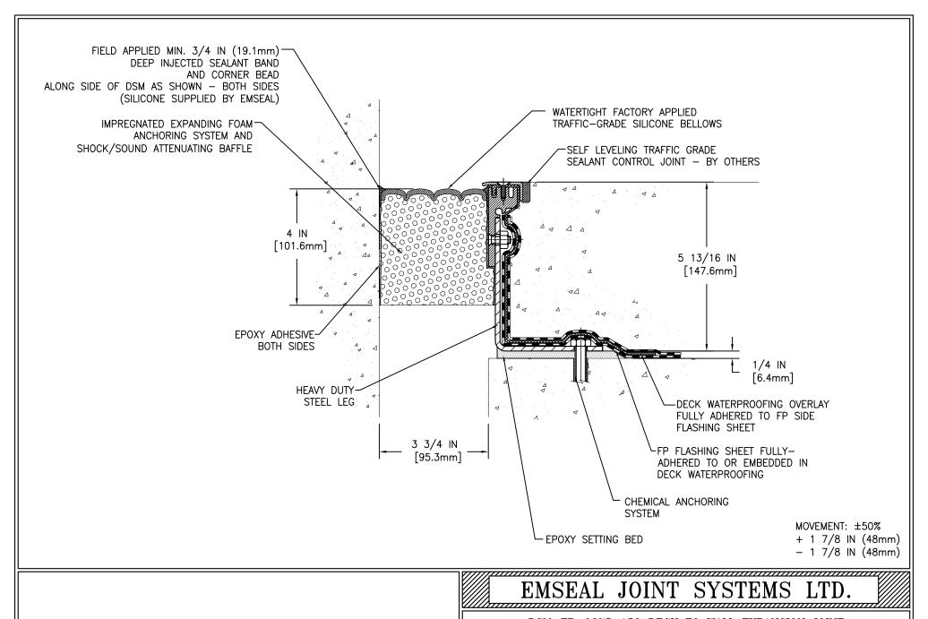
DSM-FP-0375-150 DECK TO WALL EXPANSION JOINT
