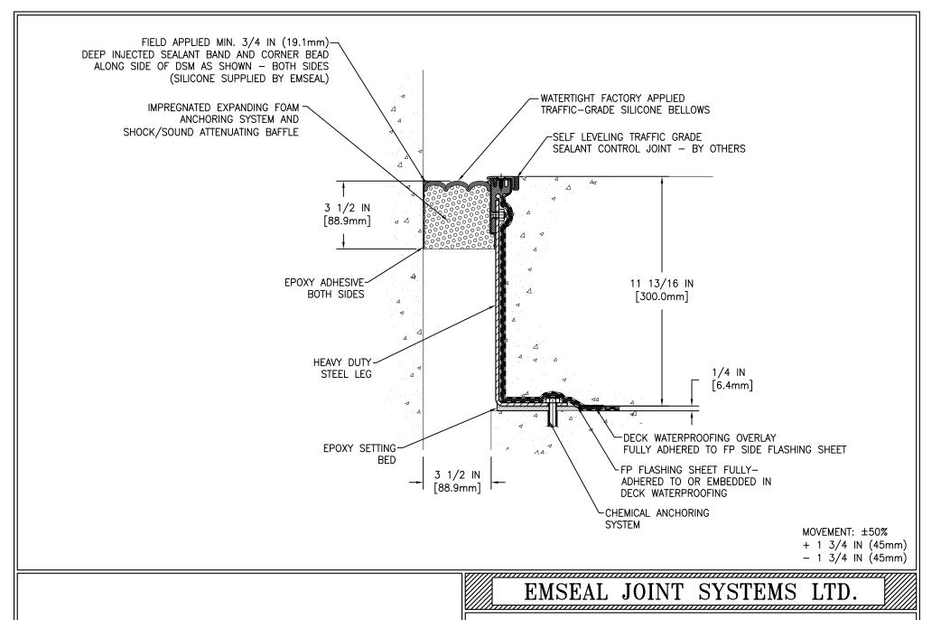
DSM-FP-0350-305 DECK TO WALL EXPANSION JOINT
