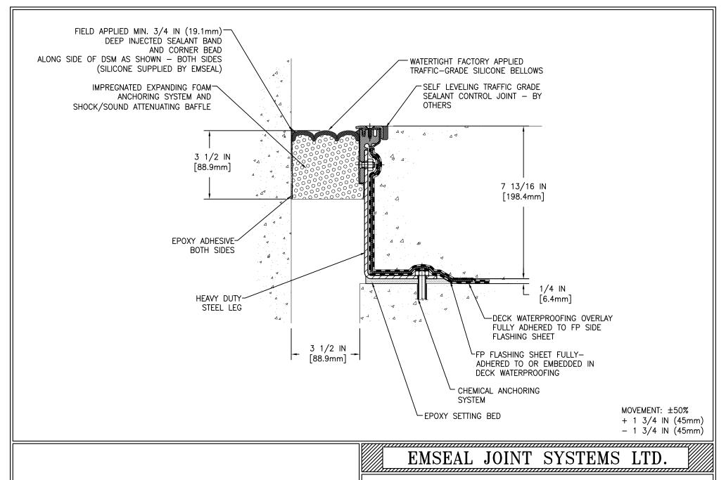
DSM-FP-0350-200 DECK TO WALL EXPANSION JOINT
