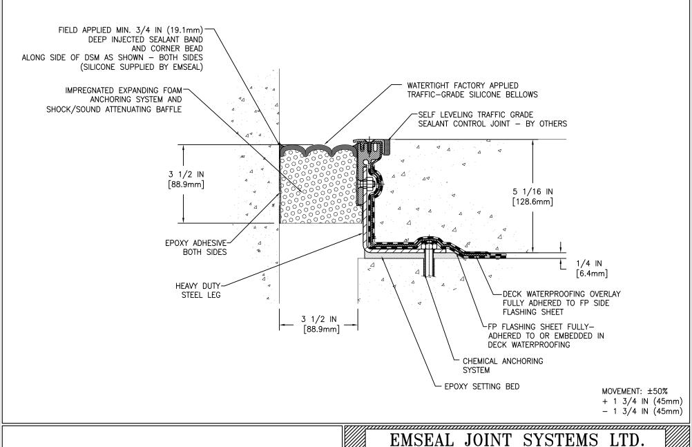
DSM-FP-0350-130 DECK TO WALL EXPANSION JOINT
