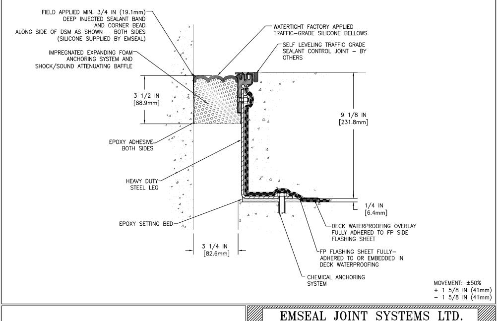
DSM-FP-0325-235 DECK TO WALL EXPANSION JOINT
