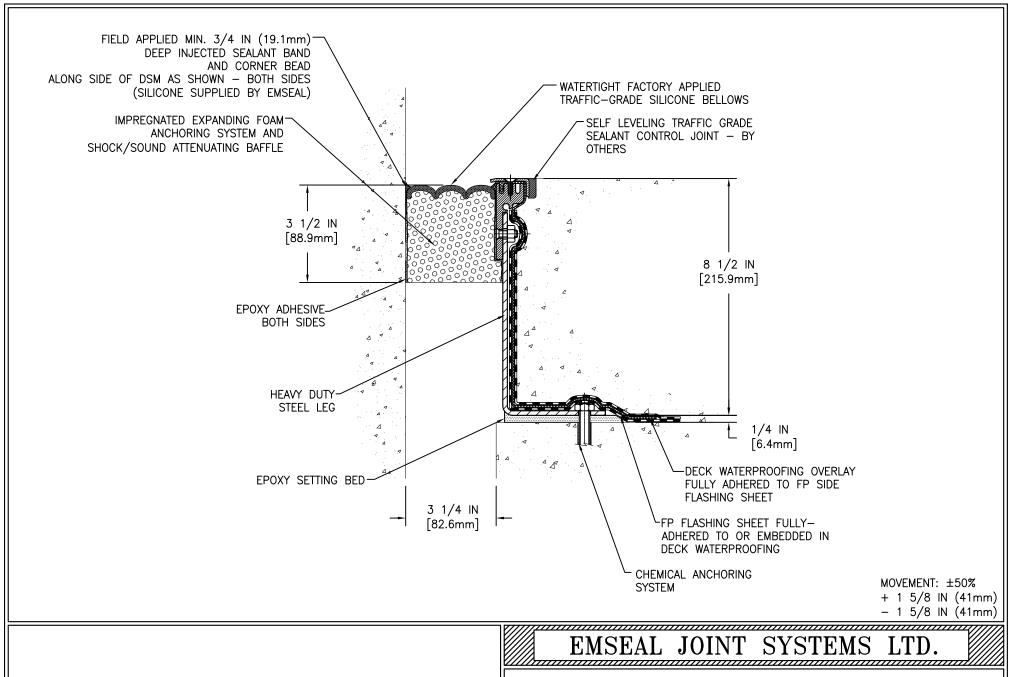
DSM-FP-0325-220 DECK TO WALL EXPANSION JOINT
