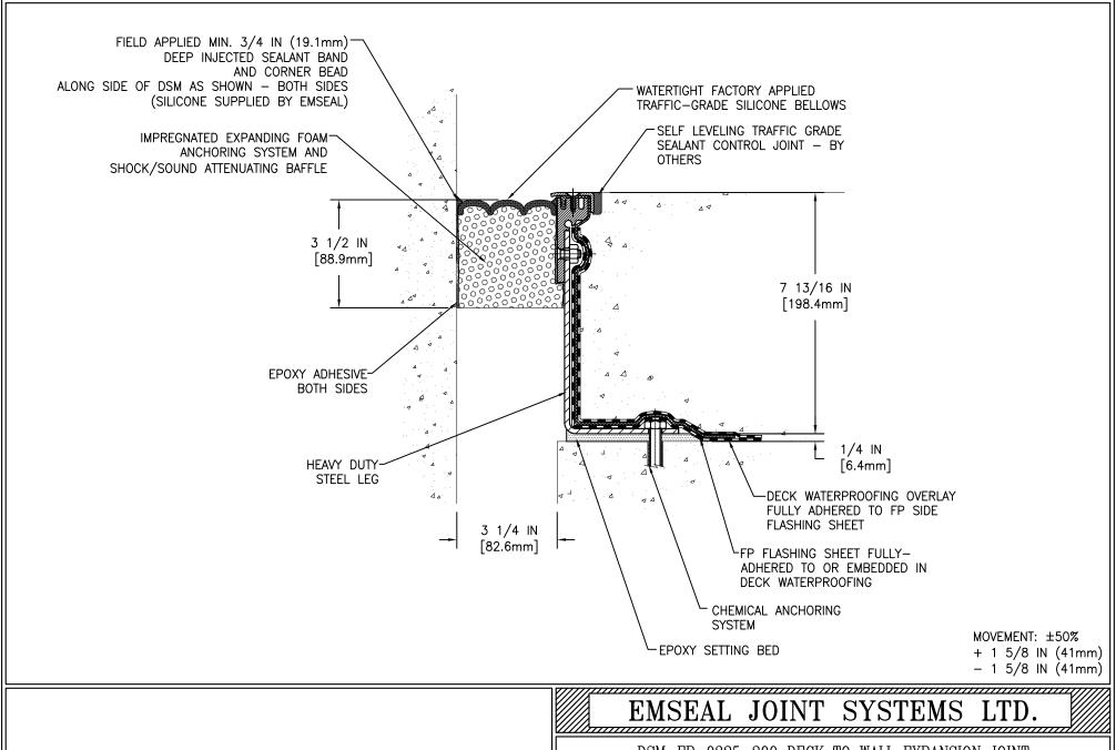
DSM-FP-0325-200 DECK TO WALL EXPANSION JOINT
