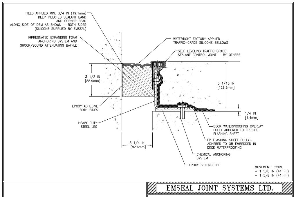
DSM-FP-0325-130 DECK TO WALL EXPANSION JOINT
