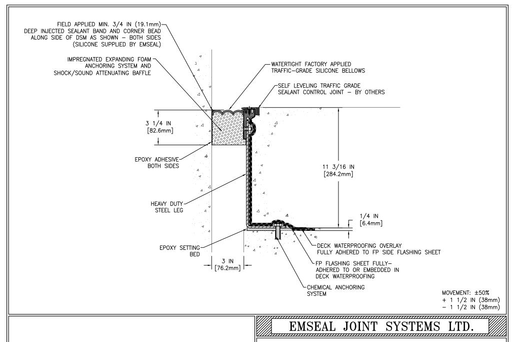
DSM-FP-0300-290 DECK TO WALL EXPANSION JOINT
