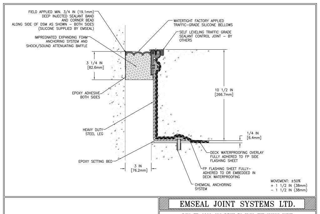
DSM-FP-0300-270 DECK TO WALL EXPANSION JOINT
