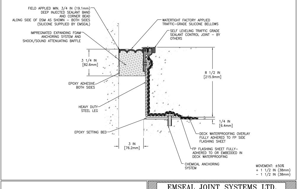
DSM-FP-0300-220 DECK TO WALL EXPANSION JOINT
