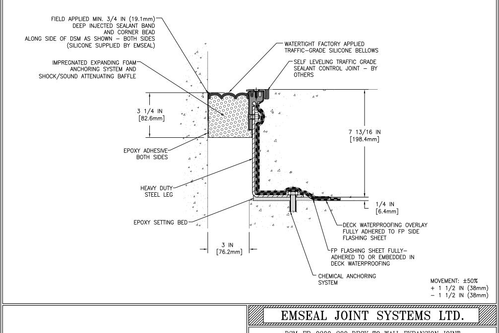
DSM-FP-0300-200 DECK TO WALL EXPANSION JOINT
