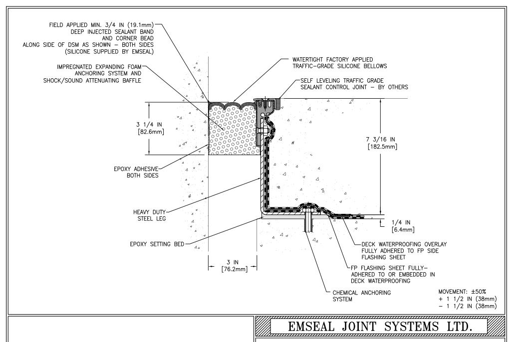
DSM-FP-0300-185 DECK TO WALL EXPANSION JOINT
