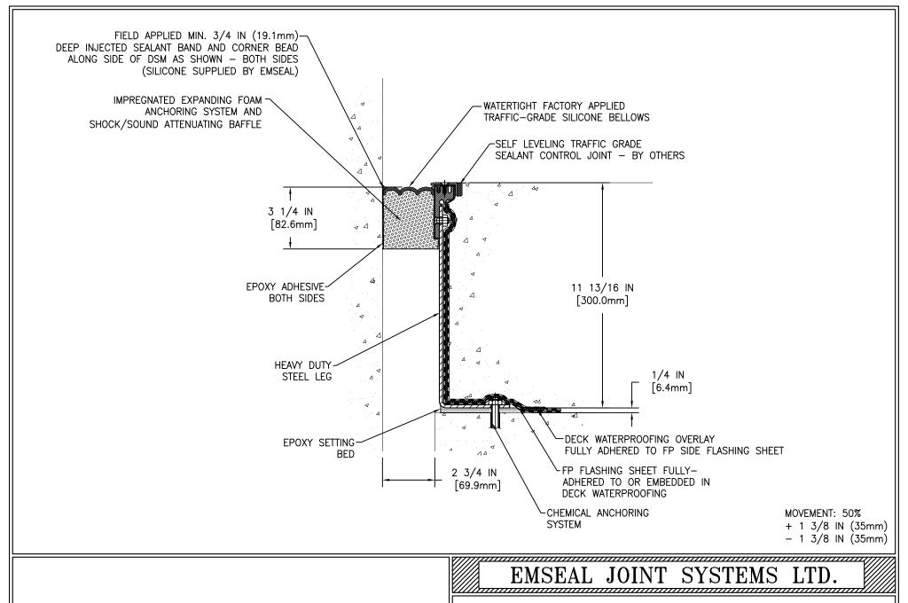
DSM-FP-0275-305 DECK TO WALL EXPANSION JOINT
