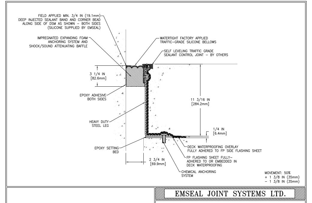
DSM-FP-0275-290 DECK TO WALL EXPANSION JOINT
