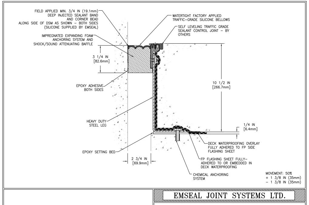
DSM-FP-0275-270 DECK TO WALL EXPANSION JOINT
