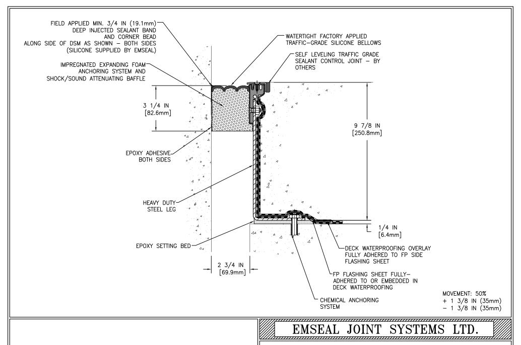
DSM-FP-0275-255 DECK TO WALL EXPANSION JOINT
