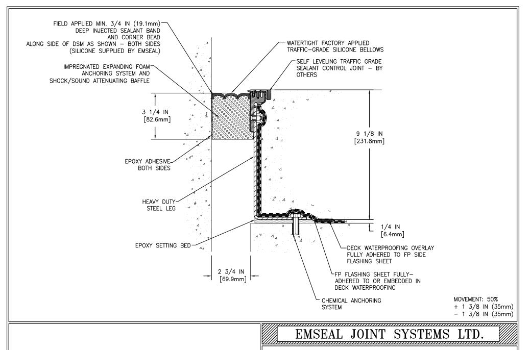
DSM-FP-0275-235 DECK TO WALL EXPANSION JOINT
