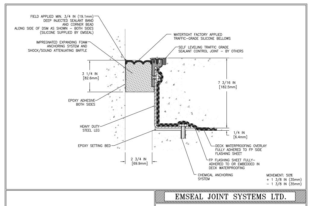
DSM-FP-0275-185 DECK TO WALL EXPANSION JOINT
