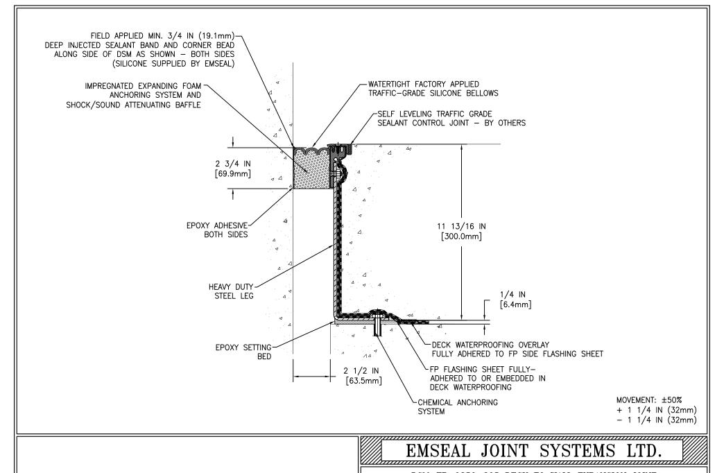
DSM-FP-0250-305 DECK TO WALL EXPANSION JOINT
