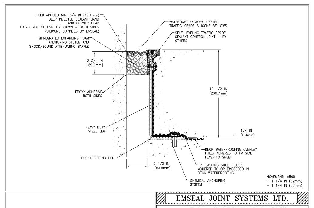
DSM-FP-0250-270 DECK TO WALL EXPANSION JOINT
