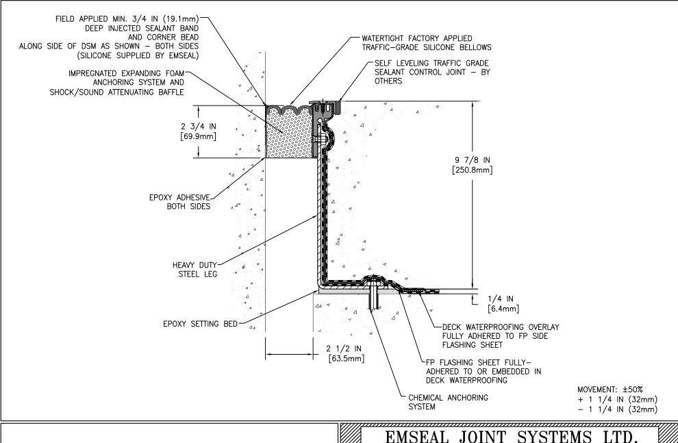
DSM-FP-0250-255 DECK TO WALL EXPANSION JOINT
