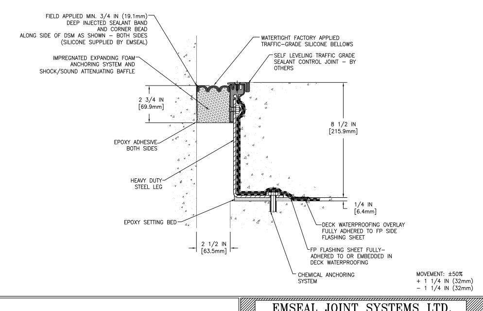
DSM-FP-0250-220 DECK TO WALL EXPANSION JOINT
