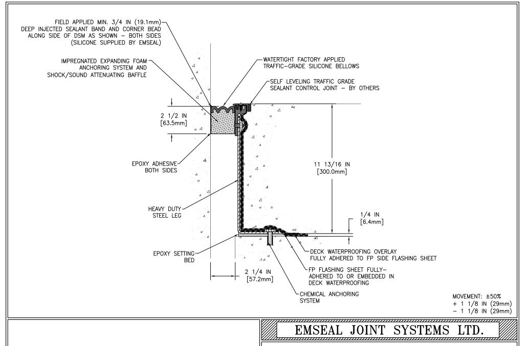
DSM-FP-0225-305 DECK TO WALL EXPANSION JOINT
