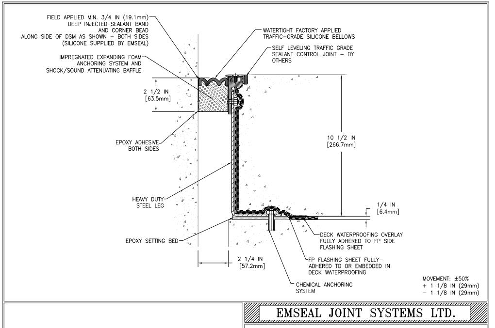
DSM-FP-0225-270 DECK TO WALL EXPANSION JOINT
