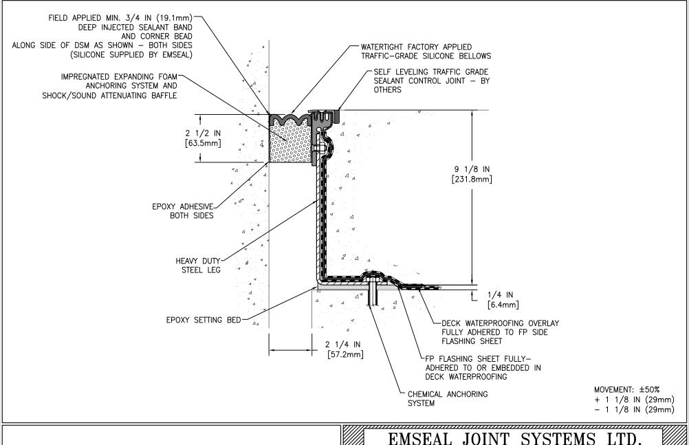
DSM-FP-0225-235 DECK TO WALL EXPANSION JOINT
