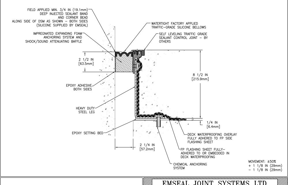
DSM-FP-0225-220 DECK TO WALL EXPANSION JOINT
