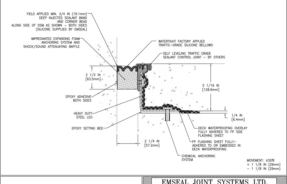
DSM-FP-0225-130 DECK TO WALL EXPANSION JOINT
