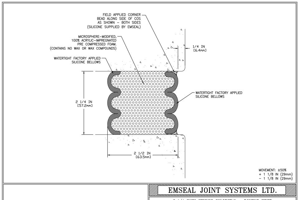
2 1/4 INCH SEISMIC COLORSEAL - DOUBLE SIDED
