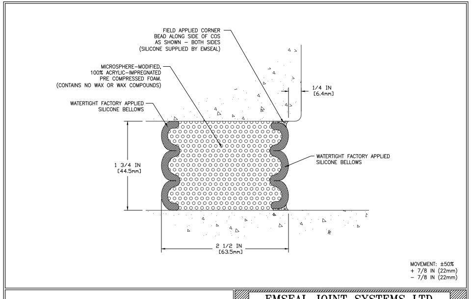
1 3/4 INCH SEISMIC COLORSEAL INSIDE CORNER - DOUBLE SIDED
