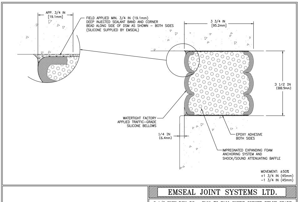
3 1/2 INCH DSM-DS - WALL TO WALL INSIDE CORNER BELOW GRADE
