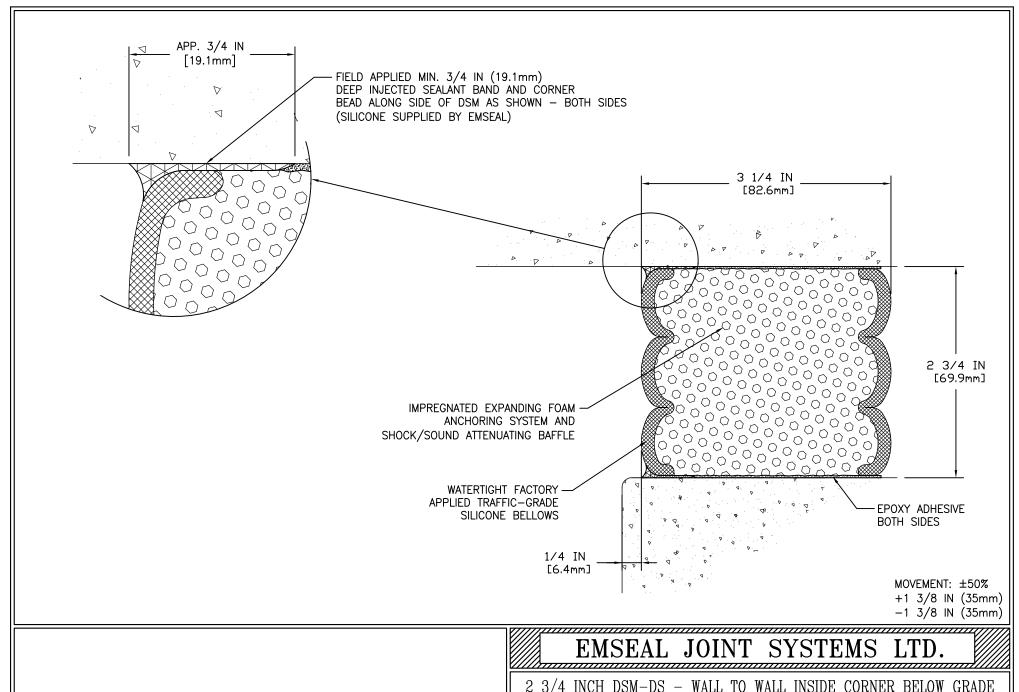
2 3/4 INCH DSM-DS - WALL TO WALL INSIDE CORNER BELOW GRADE
