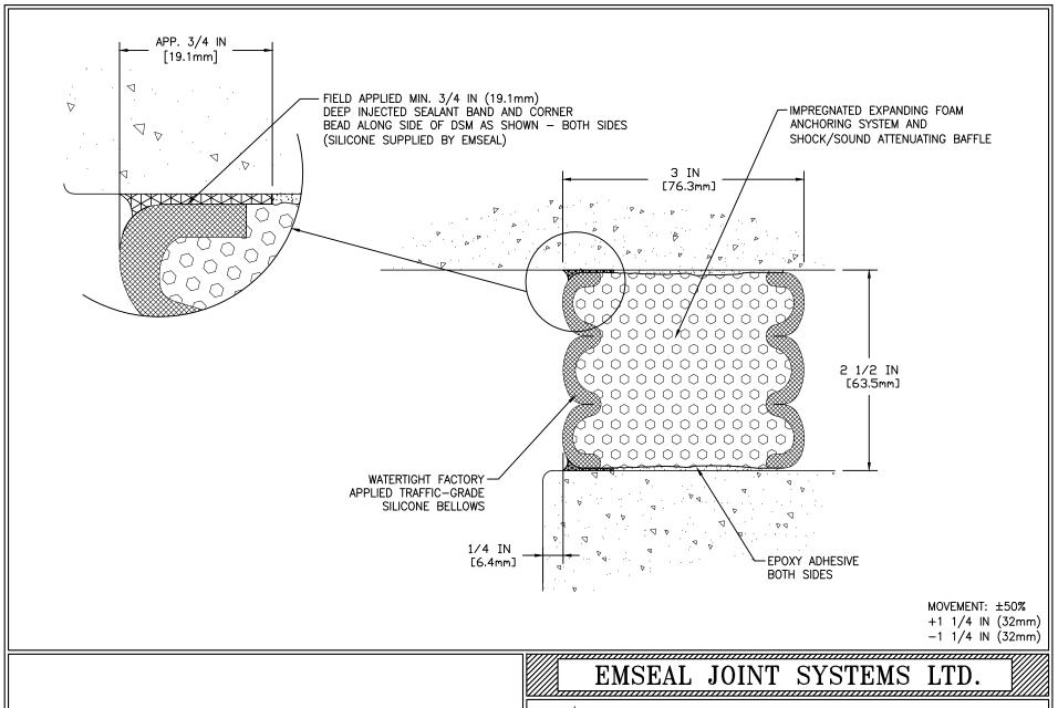
2 1/2 INCH DSM-DS - WALL TO WALL INSIDE CORNER BELOW GRADE
