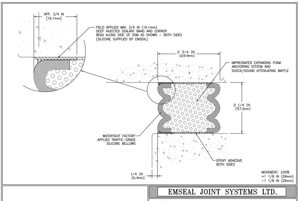
2 1/4 INCH DSM-DS - WALL TO WALL INSIDE CORNER BELOW GRADE
