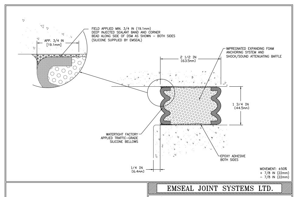
1 3/4 INCH DSM-DS - WALL TO WALL INSIDE CORNER BELOW GRADE
