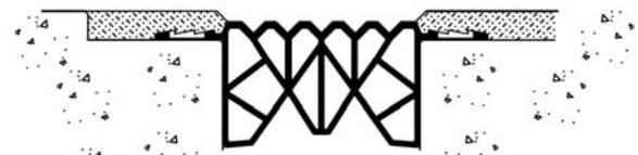
THERMAFLEX изготовлен из прессованной термопластической резины Santoprene®, перфорированные фланцы герметизирующего уплотнителя заливаются высокопрочной, гибкой, амортизирующей предохранительной окантовкой.
