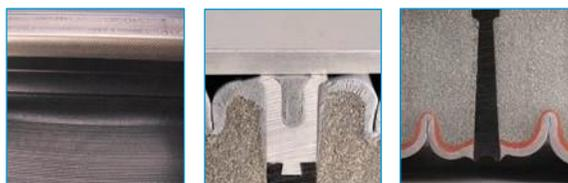
Пригодные для горячей сварки прокладки из TPR (фото слева) соединяются с гидроизолирующей системой плиты. Водонепроницаемые секции из гофрированного силикона (фото в центре) располагаются под пригодной для движения транспорта защитной накладкой. Планка (фото справа) проходит через вспучивающееся огнезащитное покрытие и внешнее силиконовое покрытие с нижней стороны SJS-FP-FR.
