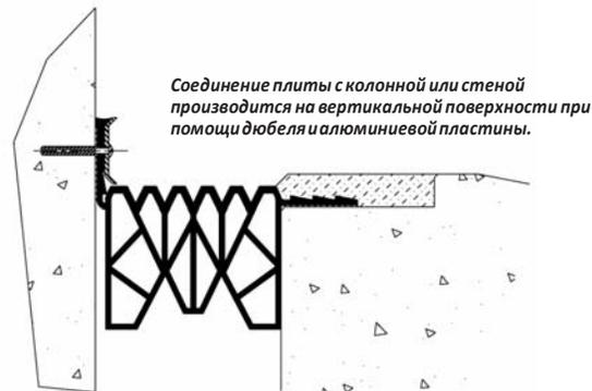
Соединение плиты с колонной или стеной производится на вертикальной поверхности при помощи дюбеля и алюминиевой пластины.
