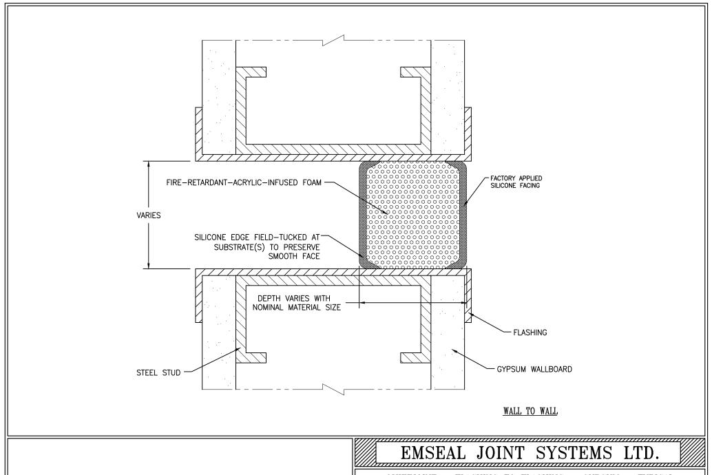
QUIETJOINT - FLASHING TO FLASHING - GYPSUM - TYPICAL
