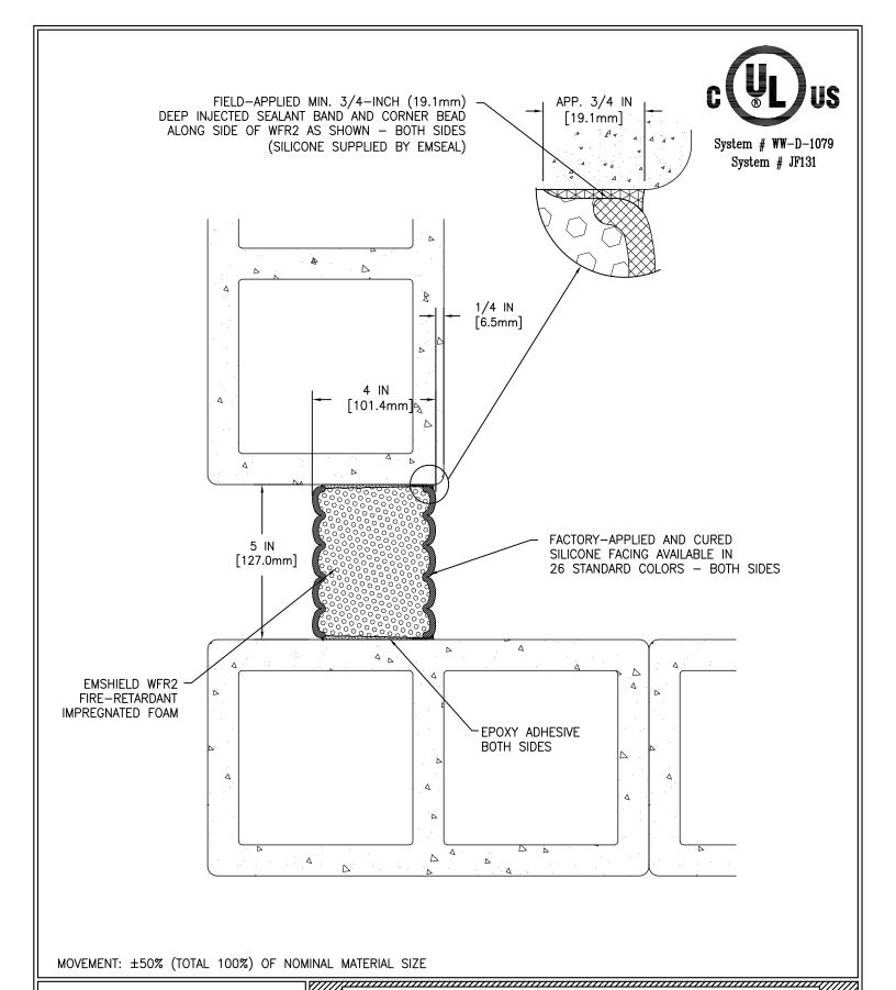
EMSEAL'S EMSHIELD WFR2 HAS BEEN TESTED IN ACCORDANCE
