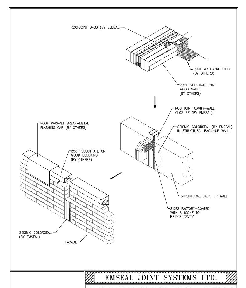
ROOFJOINT 0400 TRANSITION TO SEISMIC COLORSEAL CAVITY-WALL CLOSURE - EXPLODED ISOMETRIC
