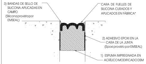
Figura 2: SISTEMA DSM en ángulos de acero existentes - Reacondicionamiento
