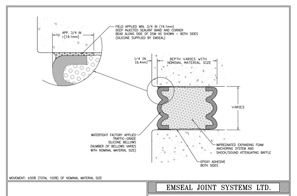
DSM-DS - WALL TO WALL BELOW GRADE - TYPICAL
