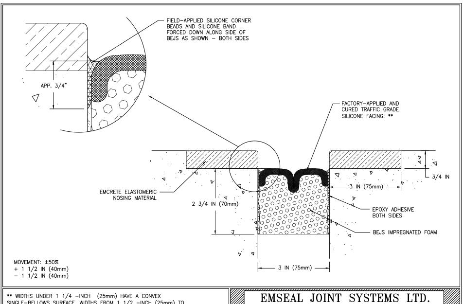
SINGLE-BELLOWS SURFACE. WIDTHS FROM 1 1/2 -INCH (25mm) TO 4-INCHES (100mm) HAVE A DUAL-BELLOWS SURFACE.
