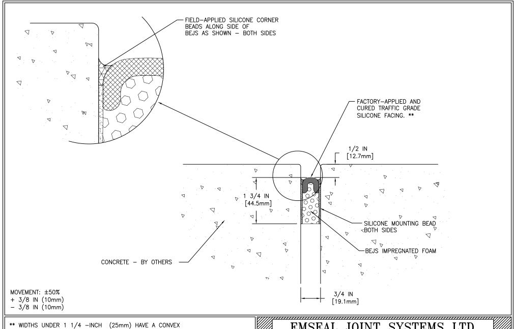
SINGLE-BELLOWS SURFACE. WIDTHS FROM 1 1/2 -INCH (25mm) TO 4-INCHES (100mm) HAVE A DUAL-BELLOWS SURFACE.
